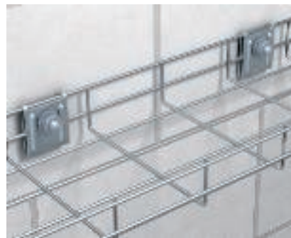
Настенное крепление проволочных лотков Крепление к стене проволочных лотков с помощью настенной скобы K12 1818. Максимальная ширина проволочного лотка 200 мм.
