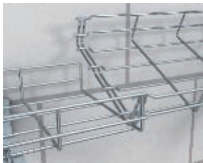
Продольное соединение проволочного лотка GR-Magic® Продольное соединение проволочных лотков GR-Magic® путем установки секций лотка 2-х типов длины друг в друга, без применения болтов.
