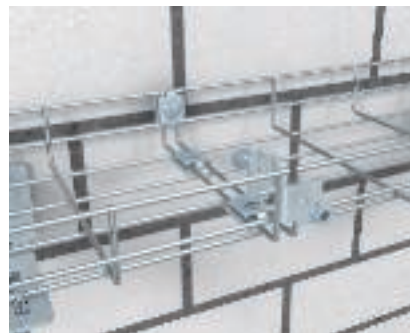
Продольное соединение проволочных лотков с помощью болтов Продольное соединение проволочных лотков с помощью стыковых соединителей GSV 34 и болтов.
