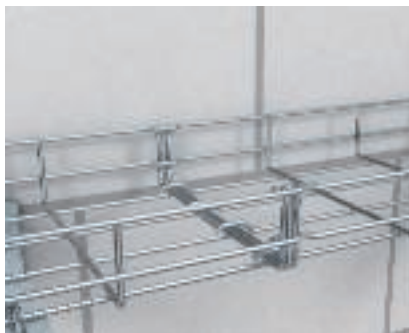
Продольное соединение проволочного лотка GR-Magic® Прочная и надежная фиксация обеспечивается благодаря установке секций лотка друг в друга.
